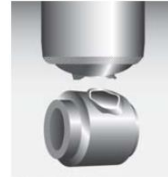
Soporte inferior o superior dañados
