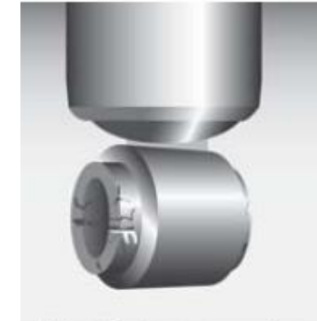
Buje inferior o superior dañados
